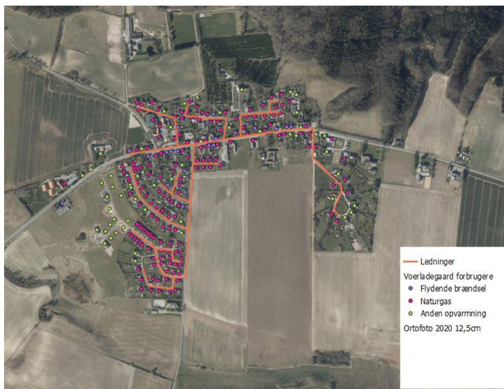
Figur 10 viser hvor olie og gaskunderne er placeret samt hvilke kunder som har en alternativ opvarmningsform i Voerladegård
